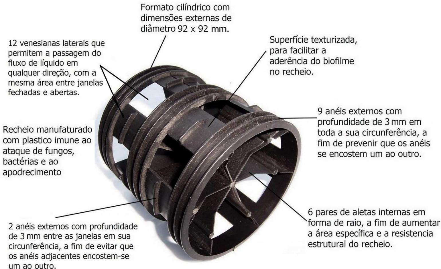
Os anéis Bioring 90, são recomendados para aplicações em filtros de percolação (trickling filter) ou sem sistemas afogados, tais como filtros biológicos aeróbicos e filtros biológicos anaeróbicos. Os solidos normalmente devem ser removidos antes da entrada do efluente no digestor. O recheio é resistente a degradação de raios ultravioleta, erosão, desintegração, rachaduras, quebradiço, farelar-se em operação ou manuseio, a acidos comuns e alcalinos e compostor orgânicos.
