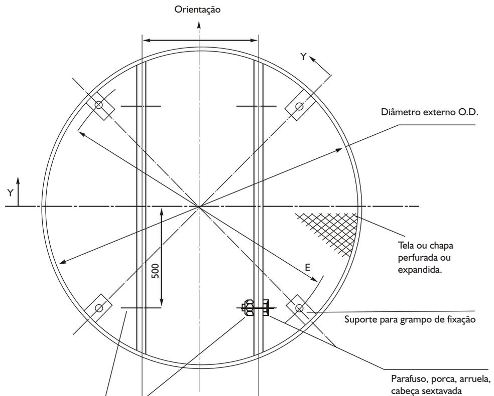
Apoiar o limitador sobre o recheio nivelado, fixar as partes do limitador entre si.
